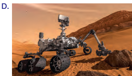
REPRESENTAÇÃO DA SONDA ESPACIAL CURIOSITY, QUE ESTÁ EM MARTE. ELA SE DESLOCA POR RODAS E TEM UM BRAÇO ROBÓTICO.
